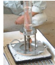
現場透水性試験装置にて試験
